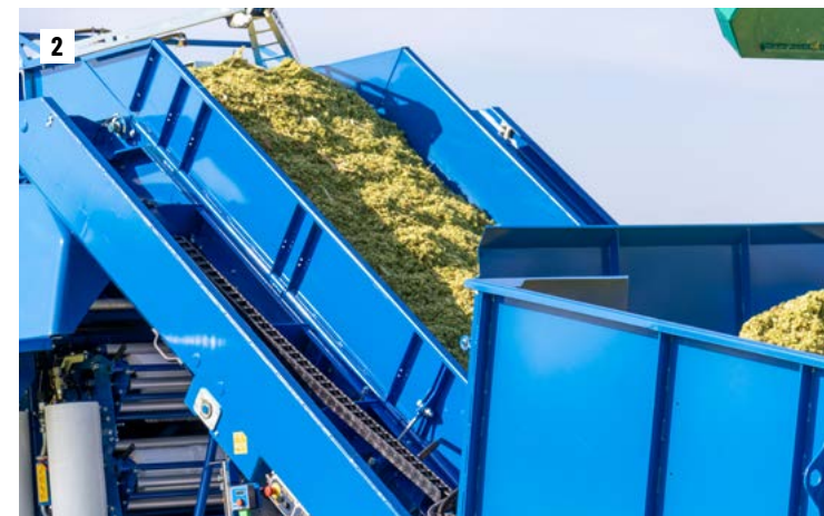
Materiał trafia z podajnika do przenośnika stromonośnego po idealnym dozowaniu
