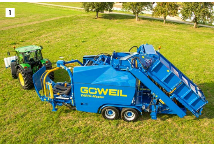
1 Prawidłowe ustawienie prasoowijarki VARIO-Master V140 i wychylenie dyszli
