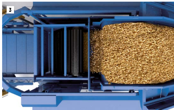
Materiał opada do komory prasowania z przenośnika stromonośnego
