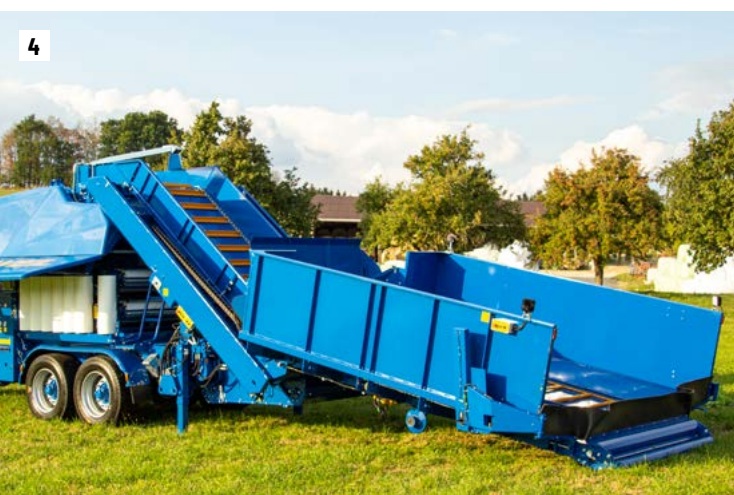
4 Rozkładanie ścianek przenośnika stromonośnego oraz podajnika
