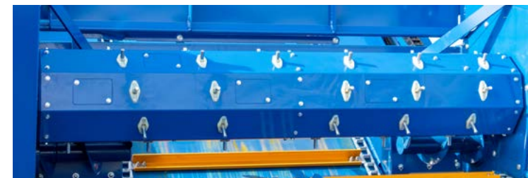
Bęben dozujący podajnika Multicrop
