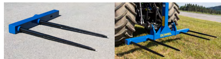
Zestaw do przebudowy w sworzeń transportowy do bel, podwójny
