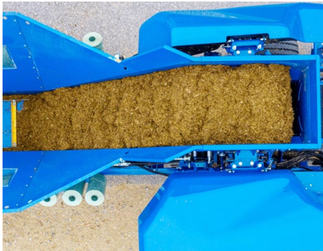
Przebieg stromośny transportuje materiał do komory prasowania
