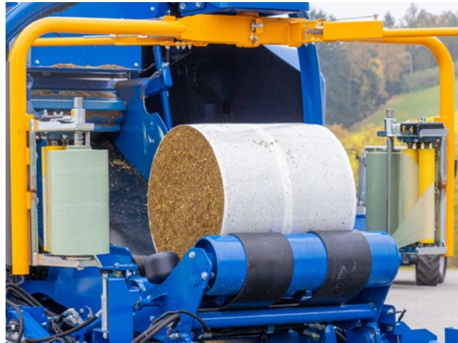
Przekazywanie beli z komory prasowania na stół owijarki
