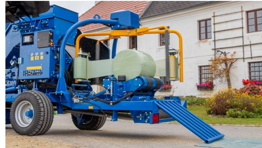
Następuje szybkie owinięcie beli, a potem zrzut przez rampę zrzutu bel
